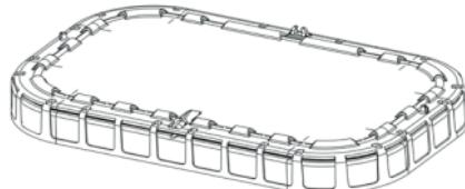
**Obs.: A limpeza do filtro deve ocorrer a cada 2 (dois) meses e a troca do refil de palha a cada 6 (seis) meses. Essa limpeza ou troca pode variar de acordo com a severidade de aplicação do climatizador.**
