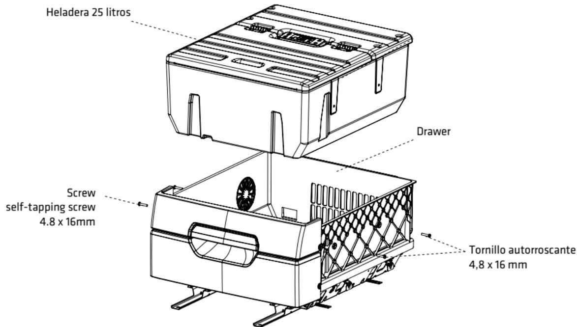
**Nota 1:** Los tornillos deben ser fijados con bajo torque, pues la heladera encaja perfectamente en el cajón original del camión. La fijación de los tornillos sirve para un mejor ajuste entre cajón y frigorífico, eliminando posibles holguras.
