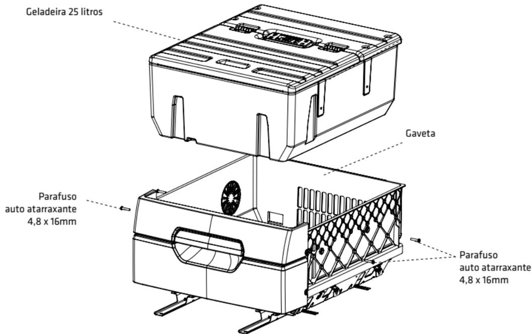
Nota 1: A fixação dos parafusos deve ser realizada com baixo torque, pois a geladeira encaixa de forma perfeita na gaveta original do caminhão. A fixação dos parafusos serve para um melhor ajuste entre gaveta e geladeira, eliminando possíveis folgas.
