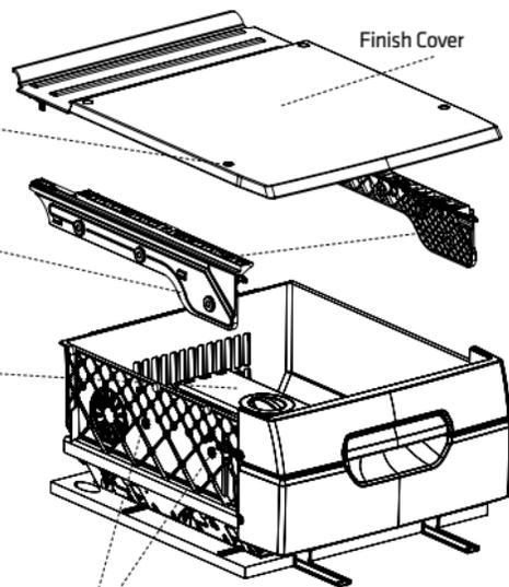
Hacer un orificio de  $\varnothing 6$  (4x) para la fijación de la Heladera, en la región demarcada.
