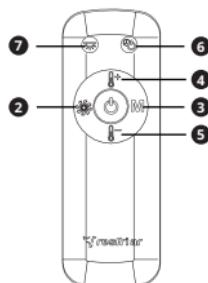
Las teclas de acceso a las funciones del panel de control son "touch" y cuentan con retroiluminación. Las teclas del control remoto utilizan un interruptor de presión.
