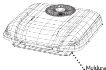
A entrada de ar é por trás e por baixo do aparelho. Limpe embaixo, entre o teto e a base do aparelho. O espaço é restrito (mínimo de 25mm).
