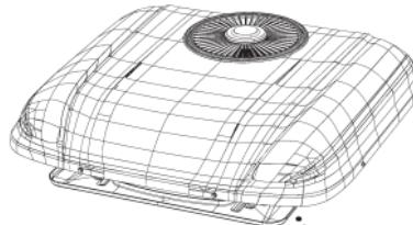
La entrada de aire está detrás y debajo del aparato. Limpie por debajo, entre el techo y la base del aparato. El espacio es limitado (mínimo 25 mm).
