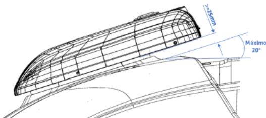
**10.1:** Debe haber una distancia mínima de 25 mm entre la base del aire acondicionado y la superficie del techo para que el aire pueda entrar en el condensador sin perder flujo.
