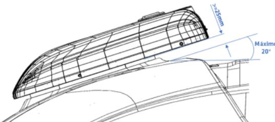
**10.1:** Deve haver uma distância mínima de 25mm entre base do AC e a superfície do teto para que o ar possa entrar no condensador sem perder vazão.
