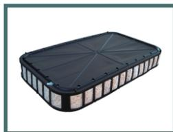
**Filtro Evaporativo:** Posicionado dentro da bacia, tem a função de reter impurezas, pó e insetos. Também é responsável pela umidificação do ar, que ao atravessá-lo mistura-se com a água, acontecendo assim a troca de calor (climatização).
